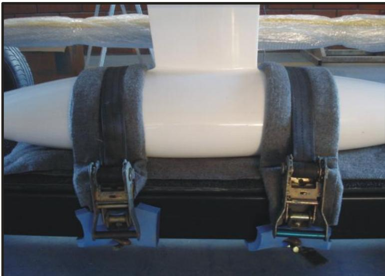
Entre a lamina da quilha e casco, deve ser colocado feltro, fixando com fita adesiva.
